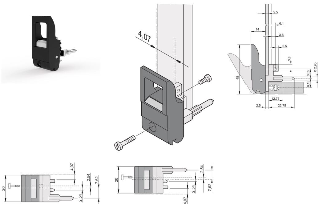
Ein- und Aushebegriff Typ IET nach IEEE 1101.10. Pro Paar erzeugen die Griffe eine Hebelkraft von 700 N.
