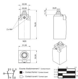
Schalter zum Anschluss an die Öffnerkontakte des Türsteuermoduls für die manuelle Türöffnung. Dies wird in erster Linie für Beleuchtungs- und Kühllösungen verwendet, die mit dem Öffnen oder Schließen der Tür verbunden sein sollen.
