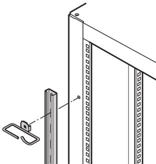
Zur Montage an den vertikalen Holmen auf der rechten und linken Seite der 19-Zoll-Ebene; besonders geeignet für Kabelschellen.
