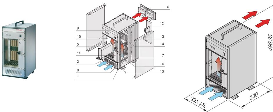
VME64 Tower-System für 7 VME64x Boards 6 HE, 160 mm. Die Stromversorgung des Systems erfolgt über ein steckbares Netzteil. Ein Lüftersteuerungs-Modul überwacht die Lüfter, die Temperatur und die Spannung.
