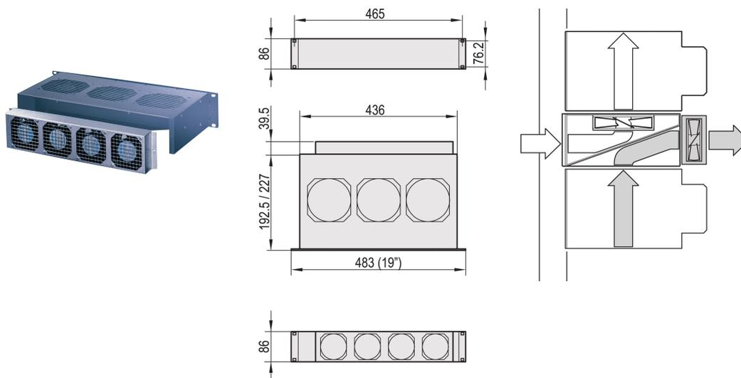
Zusätzlicher Lüfter (angebaut) mit Gehäuse für Schroff Pusher-Lüfter 2 HE. Keine zusätzliche Spannungsversorgung notwendig: Anschluss erfolgt über 19" Pusher-Lüfter.
