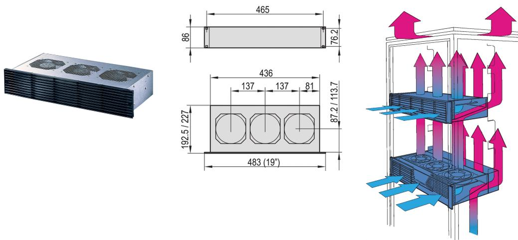
Lüftereinschub mit integriertem Drucklüfter.
