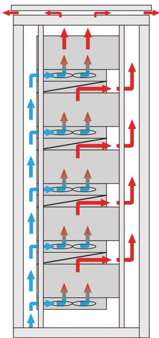
Der Luftleiteinschub mit 1 HE Höhe leitet die Luft entweder von vorne nach oben oder von unten nach hinten.
