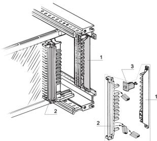
Die Codierung ist an der Seite des Steckverbinders angebracht. Durch die Codierung passt nur die codierte Leiterplatte in den richtigen Slot.
