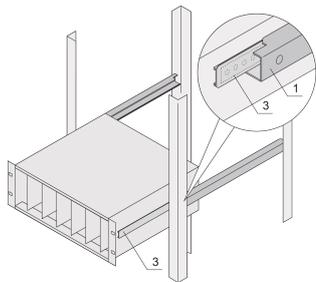
Das an der Seitenwand des Baugruppenträgers montierte C-Profil dient zur Befestigung des Baugruppenträgers am Führungsprofil beim Einbau in einen Schrank.
