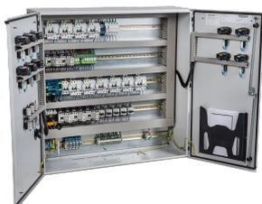
Der nVent RAYCHEM SBS-XX-SNR-Schaltschrank bietet eine integrierte Lösung für selbstregelnde nVent RAYCHEM-Heizkabel in Sprinkler-Frostschutzanwendungen. Er bietet Mehrfachschaltung, Mehrfachsensor und Mehrfachsteuerung mit integriertem elektrischem Schutz und automatischer Redundanzschaltung gemäß BS EN 12845:2008. Eine Stromversorgung von 400 V AC (3-phasig) ist erforderlich.
