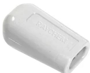
Die nVent RAYCHEM RayClic-E-XX-Endabschlüsse sind einfache, schnelle und zuverlässige Endabschlüsse, die für eine Auswahl von selbstregelnden nVent RAYCHEM XL-Trace-, IceStop- und HWAT-Heizkabeln entwickelt wurden. Es sind keine Heißluftgebläse oder Abisolierarbeiten erforderlich, da für den elektrischen Abschluss eine Silikon geltechnik verwendet wird.
