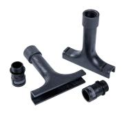
nVent RAYCHEM IEK sind eine Reihe von Isolierungseinführungssätzen zum Schutz von Strom- und Heizkabeln bei der Durchführung durch die Blechummantelung der Dämmschicht an Rohrleitungen, Tanks oder Behältern.
