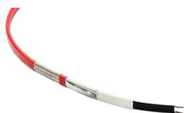
Die selbstregelnden nVent RAYCHEM HWAT-Begleitheizbänder halten die Wassertemperatur im Warmwasserverteilungsnetz eines Gebäudes aufrecht. Sie werden unterhalb der Wärmedämmung installiert. Dort gleichen automatisch auftretende Rohrwärmeverluste aus und bieten eine energieeffiziente Lösung.
