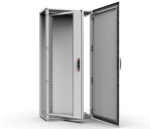
Ein Schwenkrahmen für 19"-Geräte, der zusätzlichen Einbauraum für diese Geräte sowie bei Öffnung einen Zugang von hinten zu den eingebauten Komponenten und Geräten bietet. Er bietet auch zusätzlichen Platz für die Verkabelung und erhöht die Nutztiefe für Geräte, die am Schwenkrahmen befestigt werden.
