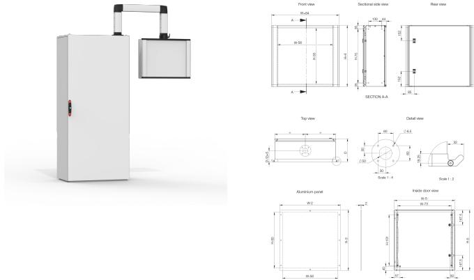
Der Bedienerschnittstellen-Schalschrank OICE aus Stahlblech hat ein vorgearbeitetes Lochmuster zur Befestigung eines Schwenkarms sowie eine abnehmbare Frontplatte mit Schutzart IP 55. Die Komponenten können dank der abnehmbaren Frontplatte leicht montiert werden, sind aber auch über eine rückwärtige Tür leicht zugänglich. Seitengriffe am Schalschrank ermöglichen das einfache Bewegen des Schranks in die Arbeitsposition.
