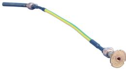
Erdungsbrücken sind Baugruppen zwischen einem Erdungspunkt mit hochwertiger Ableitung (Verbindungsterminal) und verschiedenen Leiterarten. Die Verbindung wird über den exothermen nVent ERICO Cadweld Verbindungsprozess hergestellt, der eine hochgradig korrosionsbeständige Montage mit hoher Lebensdauer ermöglicht.
