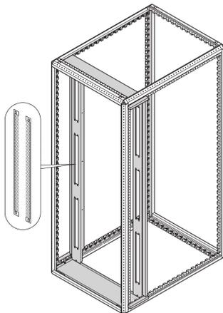
Bürstenleiste zum Verschließen von 2 HE mal 19-Zoll Ausbrüchen für Luftmanagement-Blindplatten. Vierkantlochbefestigung mit Käfigmuttern.
