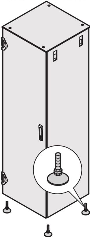
Verstellbare FüÙe oder NivellierfüÙe lassen sich am Schrankgestell montieren. Dies sorgt für Stabilität des Gestells auf unebenen Flächen.
