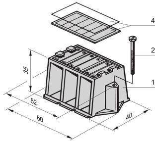
Montagewinkel für Sammelschienen oder Sammelschienenmodule sind vom Lastkreis getrennte Montageeinheiten für Erdungsschienen. Adapter mit zugewiesenen Nennströmen können vorhanden sein, die den Verbraucherabgangsleitungen den Arbeitsstrom über Kabelverbindungen zuführen.
