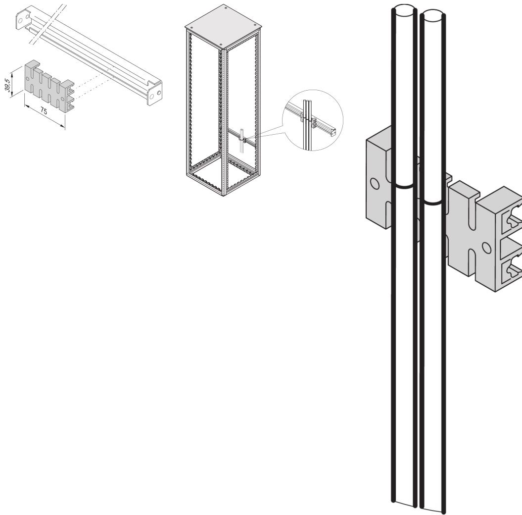
C-Schienen dienen dem besseren Kabelmanagement. Die Installation erfolgt in der Regel hinter den 19-Zoll-Holmen. Sie sind kompatibel mit Standard-Kabelschellen.
