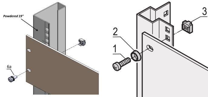
Verwenden Sie für die Standarderdung eine Erdungsmutter und eine Unterlegscheibe an mindestens einem Befestigungspunkt.
