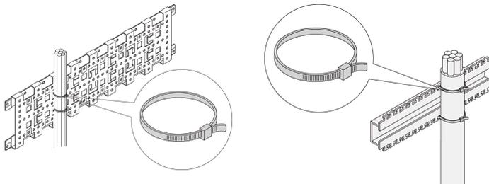
Befestigungsmaterial zur Kabelführung.
