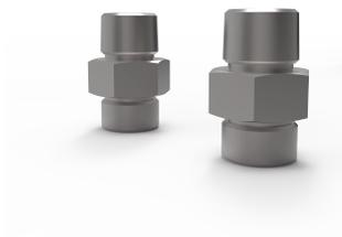
Bei diesem Sanitäranschlussadapter handelt es sich um ein Außengewinde mit einem 1-Zoll-BSPP-Flachdichtungsgewinde an einem Ende und einem 1-Zoll-NPT am anderen Ende. Mit diesem Adapter können die 1-Zoll-Schläuche in BSP-Ausführung für die Installation in NPT-Kühlwasseranlagen in US-Ausführung angepasst werden.
