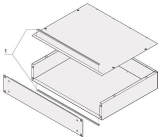
Mit dem EMV-Abschirmungssatz und den Abdeckblechen wird die Schirmung des Einschubes von ca. 30 dB(A) auf ca. 60 dB(A) erhöht. Testbericht kann heruntergeladen werden.
