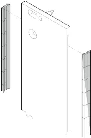
Die EMV-Dichtungen aus Edelstahl werden in die seitlichen Schlitze der abschirmbaren Frontplatten eingeschoben (2 Stück pro Frontplatte).
