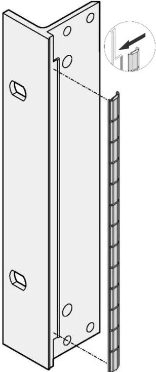
EMV-Edelstahl-Dichtungen werden seitlich in einen Slot auf der rechten Seite der U-förmigen Frontplatten eingebracht.
