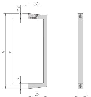
Schlanker Frontgriff aus Aluminiumprofil, 7 mm. Die Montage des Griffs erfolgt von der Rückseite.
