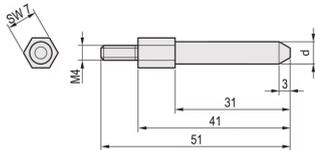
Dieser Codierbolzen/-Stift ermöglicht einen sicheren Anschluss zwischen den potentialfreien Steckverbindern für die SNCF-Baugruppenträger. Die Pins können in den Rückrahmen montiert werden.
