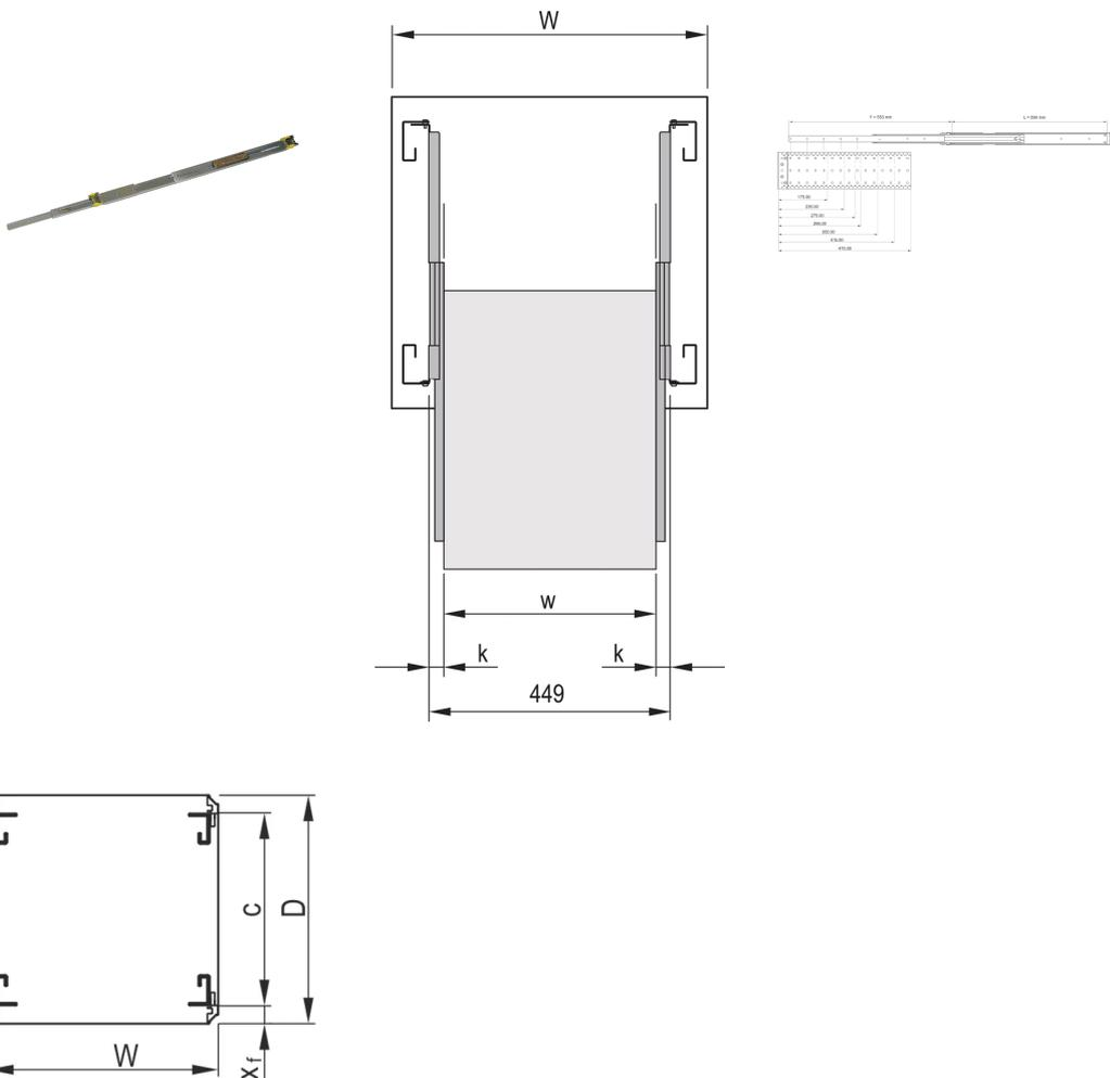
Schmale Teleskopschiene für Baugruppenträger mit >100 % Auszug.
