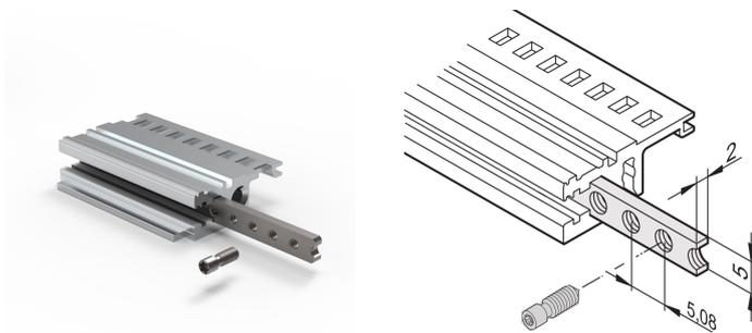
Der Gewindestreifen aus Stahl mit M2,5 Gewinde, ermöglicht die Befestigung der Lochschiene an der Tragschiene.
