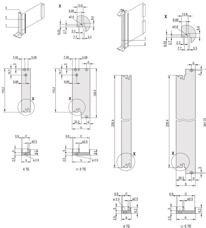
Die U-Profil-Frontplatte kann mit einer Textildichtung abgeschirmt werden. Er kann mit dem IEL- und IET-Griff oder dem Griff vom Typ 2 in Trapezform kombiniert werden, Leiterplattenmontage = 0,1 Zoll versetzt. (Offset)
