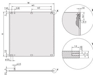
Flache Frontplatte. Abschirmbar mit EMV-Dichtung aus Edelstahl.
