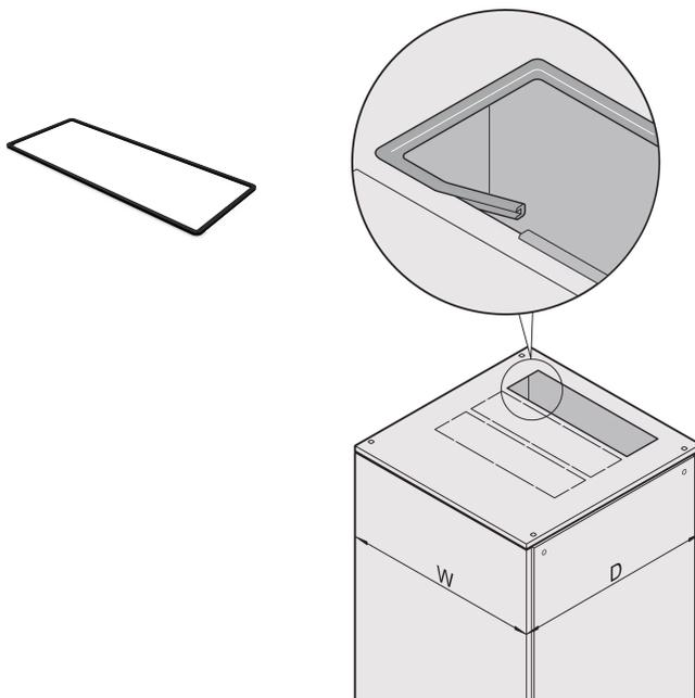
Deckt scharfe Kanten von Ausbrüchen ab. Bietet Schutz vor Verletzungen und verhindert Schäden an eingeführten Kabeln. Varistar Kantenschutz eignet sich für Ausbruchszonen des Dachs.
