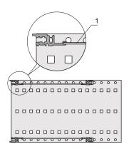
Mechanische Abdeckung von Einbauten. Die Platte wird in eine Nut der Modulschienen Typ L eingeschoben.
