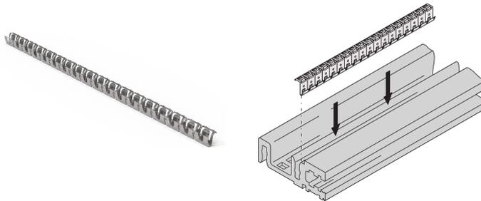
Die Edelstahldichtung wird in eine Nut der Modulschiene eingeklipst und stellt den Kontakt zum Abdeckblech her.
