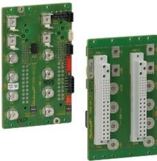
Power Backplane für CompactPCI-Anwendungen. Mit P47-Powersteckverbinder.
