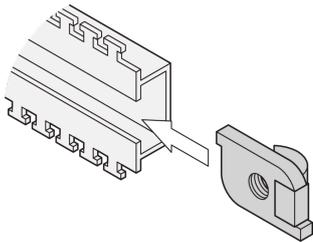
Der Schiebemuttersatz ermöglicht eine variable Montage von 19-Zoll-Komponenten außerhalb des EIA-Rasters.
