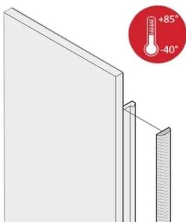
EMV-Textildichtungen werden seitlich in die Nut auf der rechten Seite der U-förmigen Frontplatte eingebracht. Die Dichtungen werden auf die Frontplatte geklebt. Geeignet für einen erweiterten Temperaturbereich bis hin zu 85+ °C.
