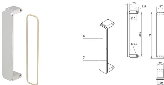
Die Mezzanine Frontplatte wird in PMC-Frontplattenausbrüche eingebaut. Erhältlich in verschiedenen Ausführungen.
