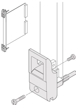
Ein- und Aushebegriff vom Typ IET in Übereinstimmung mit IEEE 1101.10. 0,1-Zoll Offset. Pro Paar erzeugen die Griffe eine Hebelkraft von 700 N.
