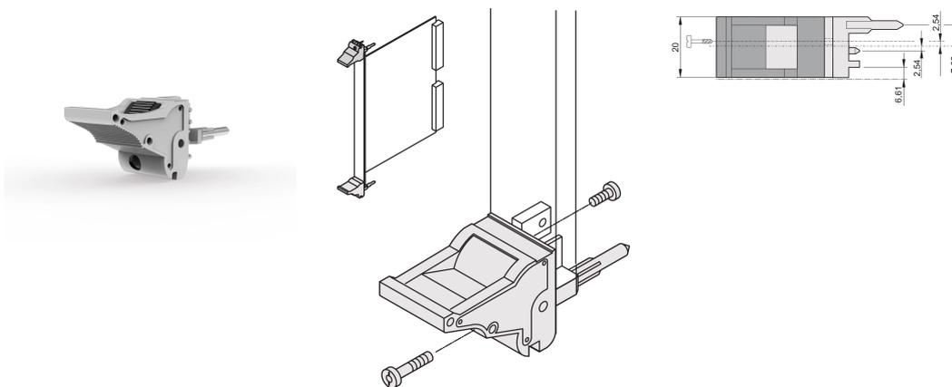
Ein- und Aushebegriff vom Typ IEL in Übereinstimmung mit IEEE 1101.10 mit 0,1-Zoll Leiterplattenversatz. Pro Paar erzeugen die Griffe eine Hebelkraft von 700 N.
