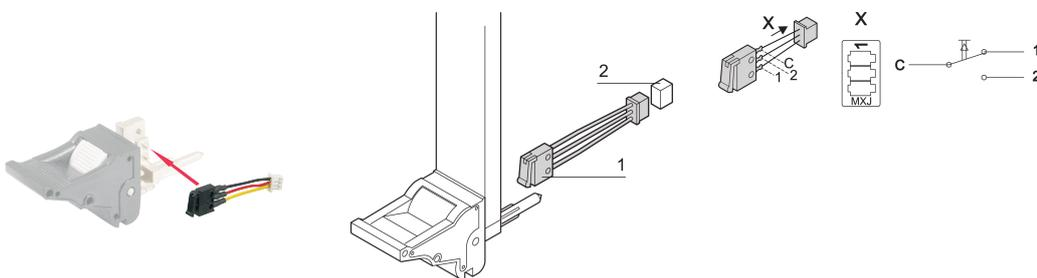
Mikroschalter für IEL- oder IET-Griff. Der Mikroschalter passt auch zu den Offset-Ausführungen des Griffs.
