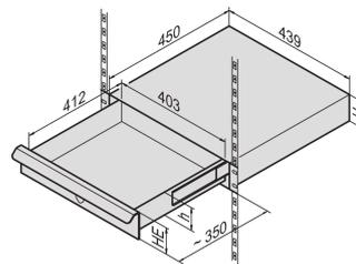
19"-Schubladen zur Montage von Laptops oder als Schreibunterlage für einfache Arbeiten. Die SCHROFF 19"-Schublade hat eine Tragfähigkeit von 15 kg, sodass eine breite Palette von Produkten darauf montiert werden kann.
