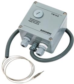
Der nVent RAYCHEM T-M-10-S/+x+y ist ein mechanischer Oberflächenerfassungsthermostat für den Nicht-Gefahrenbereich zur Temperaturregelung von Heizkabeln. Erhältlich in den Bereichen: 0 °C-50 °C; 0 °C-200 °C; 50 °C-300 °C. Die Einstellung des Temperatursollwerts kann ohne Öffnen des Gehäuses über einen Blindstopfen im Gehäusedeckel vorgenommen werden. Die direkte Verbindung des Heizkabels ist möglich, die Schaltstromkapazität beträgt 16 A.
