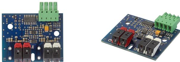
Das Modul nVent Raychem SM-TF130-DI ist nur für den Betrieb mit dem Elexant 650c-Modbus-Steuergerät vorgesehen. Es bietet zusätzliche digitale und analoge Eingänge, die für die Alarm- und Eisregenfunktion der Zentrale verwendet werden können.
