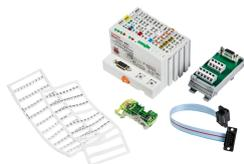
nVent RAYCHEM externe Behheizungs-Steuerungsmodule (RMC) enthalten mehrere Relaisausgänge zum Schalten von Heizkreisen, die vom nVent RAYCHEM NGC Bedienerterminal (NGC-UIT) gesteuert werden. RMC-Einheiten sind modular und können mit 2 bis 40 Relaisausgängen konfiguriert werden. Eine einzelne nVent RAYCHEM NGC-30-UIT kann über ein verdrehtes RS-485-Kabel mit bis zu 10 RMC kommunizieren. So wird eine verteilte Regelung von bis zu 260 Heizkabelkreisen ermöglicht.
