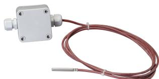
Der nVent RAYCHEM MONI-PT100-NH-Sensor ist ein Widerstandstemperturfühler aus Platin (RTD – Resistance Temperature Detector) in Zweileitertechnik, der mit einem glasfaserverstärkten Anschlusskasten aus Polycarbonat für Nicht-Gefahrenbereiche geliefert wird.
