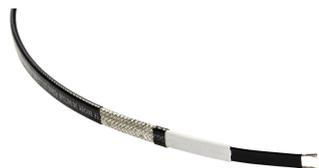
Selbstregelnde nVent RAYCHEM IceStop-Begleitheizungsbänder ermöglichen den Frostschutz von Dächern und Dachrinnen, für alle gängigen Materialien von Dachrinnen und Abflussrohren geeignet. Leistung beträgt 36 W/m bei 0 °C in Eiswasser, 18 W/m bei 0 °C in der Luft.
