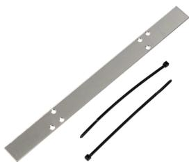
Die nVent RAYCHEM ICESTOP-GM-RAKE-Aufhängebügel für das Fallrohr dient zum mechanischen Schutz eines IceStop-Heizkabels, wenn es über scharfe Kanten gelegt wird, und zum Positionieren des Heizkabels an der Oberseite des Fallrohrs. Die GM-RAKE-Kits sind UL-gelistet, FM-zertifiziert und für die Verwendung in IceStop-Begleitheizkabelsystemen CSA-zertifiziert.
