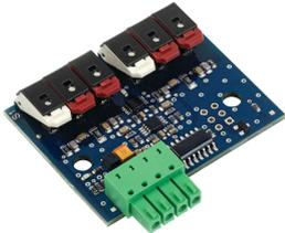
nVent RAYCHEM Elexant 450c Plug-in ist ein Sensormodul zum Austauschen alter Steuerungen ohne Notwendigkeit zum Abisolieren und Sensoraustausch.
